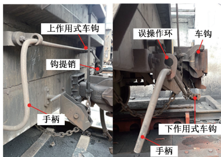
图 1 上作用式车钩和下作用式车钩
