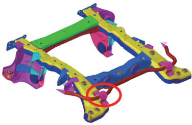
图 1 副车架与稳定杆结构
