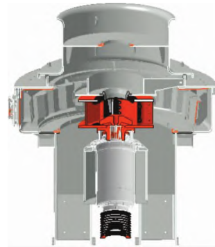
图1 立轴冲击式破碎机实际模型
