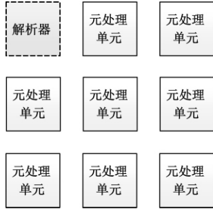
图2 数据平面硬件实现结构
