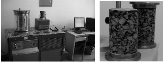
图 1 SPT 试验设备及试件
