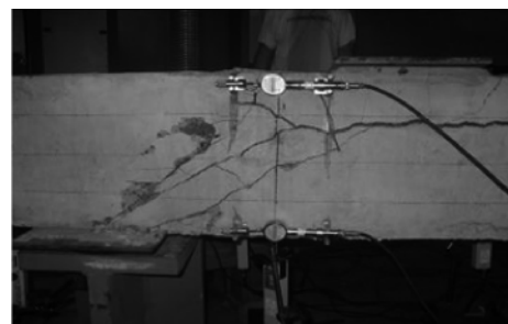
图 3 试验板静载试验最终破坏形态
