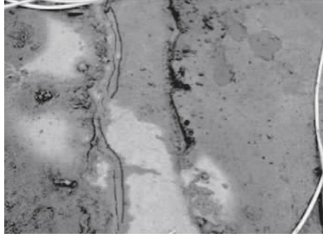
图 5 加载值 806 kN 时铰缝开裂
