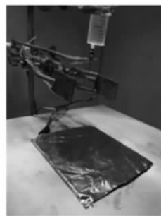
图 8 添加了平行辅助电极的静电纺丝实验装置图
