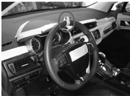
图 1 方向盘上振动传感器测点布置
