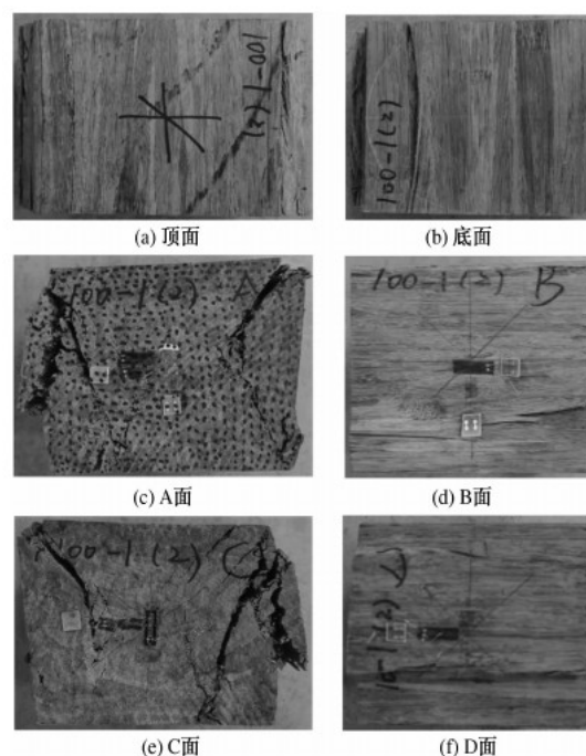
图4 横纹受压 I 典型破坏形态(2-100-1)
