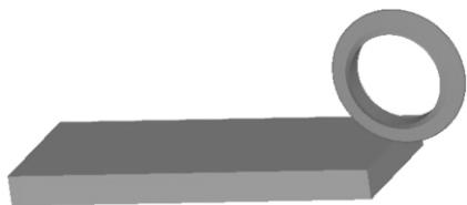
图 2 破岩仿真的几何模型
