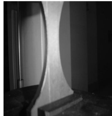
图 2 试样拉伸断裂前瞬间图
