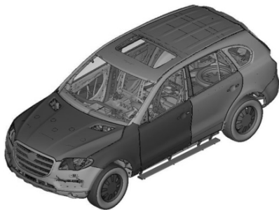
图 1 整车有限元模型
