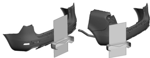
图 3 中心碰撞和车角碰撞模型
