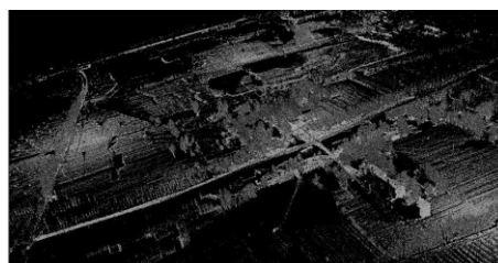
图 4 原始扫描激光点云数据
