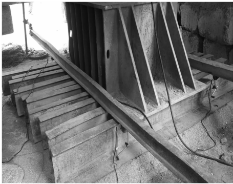
图 2 承压板放置方式示意图 Fig. 2 Placement sketch of bearing plate
