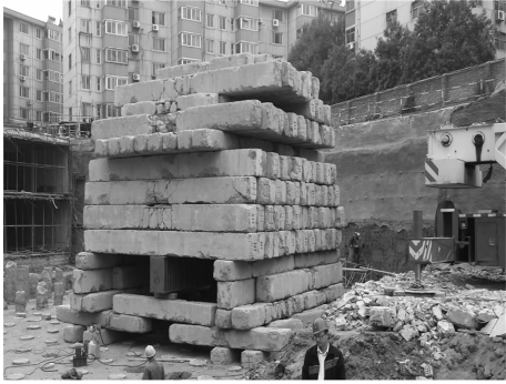
图 1 多桩静载试验加载装置图
