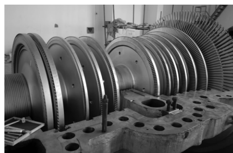
图 1 汽轮机结构
