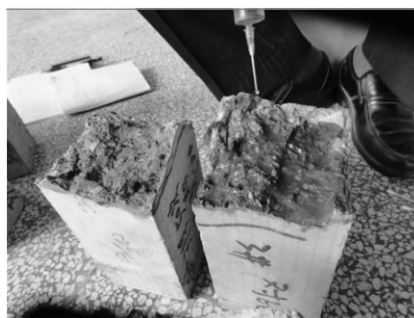
图4 铬酸钾变干后滴加硝酸银
