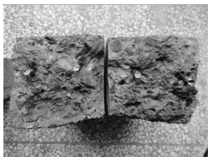
图8 采用质量分数为5%氯化钠溶液30个干湿循环的试件
