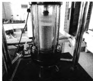
图 6 土体 c 和 \varphi 值的测定
