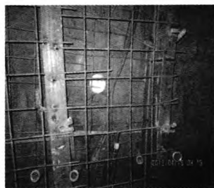
图 7 围岩压力监测
