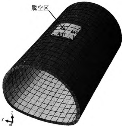
图 4 拱顶脱空示意图 Fig. 4 Schematic diagram of void behind crown
