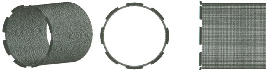
图1 刀具前角为10°的切削吸能过程三维有限元模型
