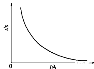
图1 熔断器的安秒特性
