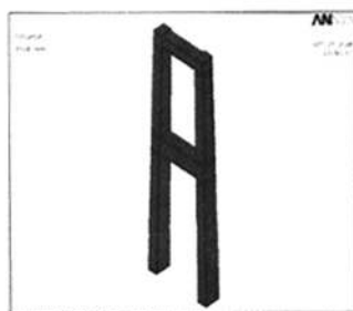
图 4 北塔实体有限元模型
