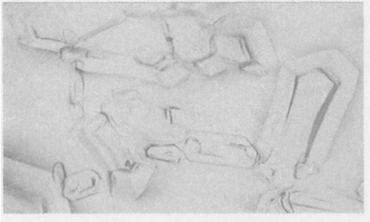
图 2 硫酸脲晶体形状 Fig. 2 The crystal shape of urea sulfate
