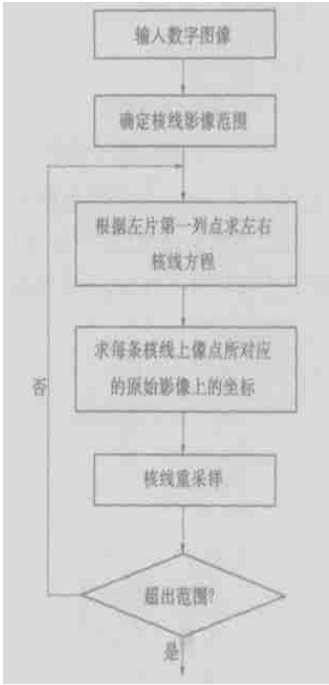
图 4 水平核线影像生成流程
