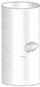
图 1 切向接管形式 Fig. 1 Form of pipe
