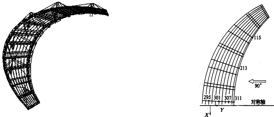
图 3 益阳体育场屋盖结构和结点位置图 Fig. 3 Roofing layout of Yiyang stadium and sketch of nodal points
