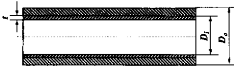
图 1 复合管结构图
