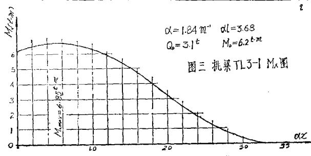
图三 挑梁 TL3-1 M<sub>x</sub> 图
