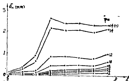
图10 组合梁B 各剪切联接件处测点水平变形实测值变化曲线
