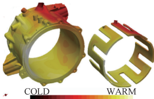
图 9 左侧壳体和右侧冷却套边界上的温度分布
