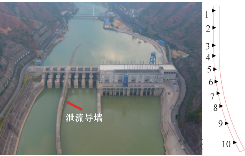
图3 导墙及测点布置
