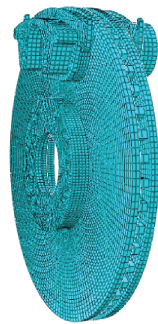
图 1 盘式制动器有限元模型
