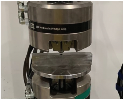
图 7 MTS 压痕硬度试验平台
