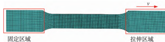
图 6 准静态拉伸试样有限元模型
