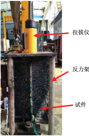
图 2 试验加载系统
