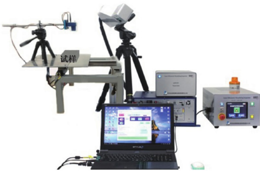
图 4 激光超声设备
