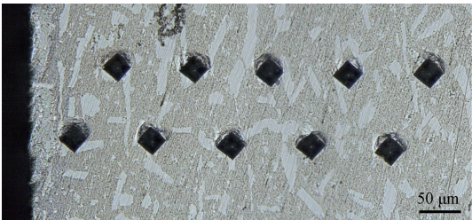
图 3 7 号试样截面的梯度硬度压痕照片
