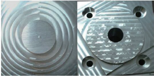
图 2 本文设计的阶梯轴样件
