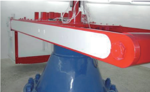
图 5 50gt 土工离心机 Fig.5 50gt geotechnique centrifuge
