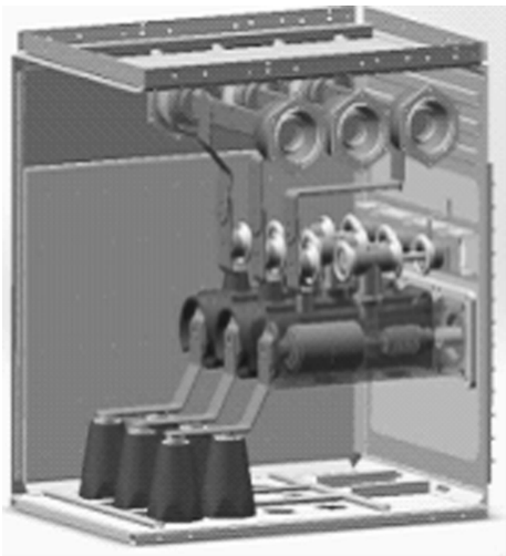
图 6 优化后气室三维模型
