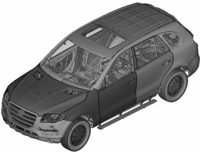
图 1 整车有限元模型 Fig. 1 Finite element model of the vehicle
