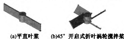
图 1 两种桨型结构图
