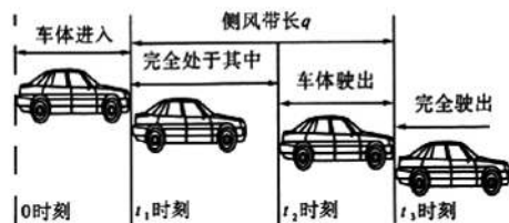
图1 侧风敏感性试验的4个阶段
