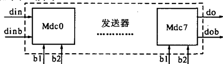
图 2 USB2.0 接口芯片物理层中的发送器电路
